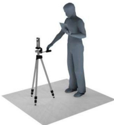
Figura 4: Medición de Iluminancia horizontal
